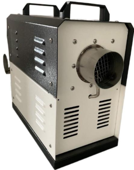
便携式烘干热风机的就业道理是：有鼓风机发生气流，气体进来加热器里从螺旋状加热丝的两边平均的经过，这个过程充分的实行热交换出来的是热风，相关热风的温度异常，当设定为某一温度，譬如说是150℃时，这个150℃不妨自己设定，在出风口上装有热电偶，当出风口温度小于150℃时加热器会向来就业，使出风口风温不断提升，当风温达到150℃时加热器停止就业，余温会使出风口温度在150℃左右来回，温控精度为±1℃，当出风口温度低于149℃时加热器会继续就业，是出风口温度维护在150℃左右，左右不同不会抢先±1℃。风机的风量可有调动，通常小功率的不妨由风门来操纵风量，大功率抑或正确控风的不妨用在风机上装配变频器来操纵风量。辽宁工业型烘干热风机烘干热风机不能靠近火源，否则容易损坏烘干热风机。
